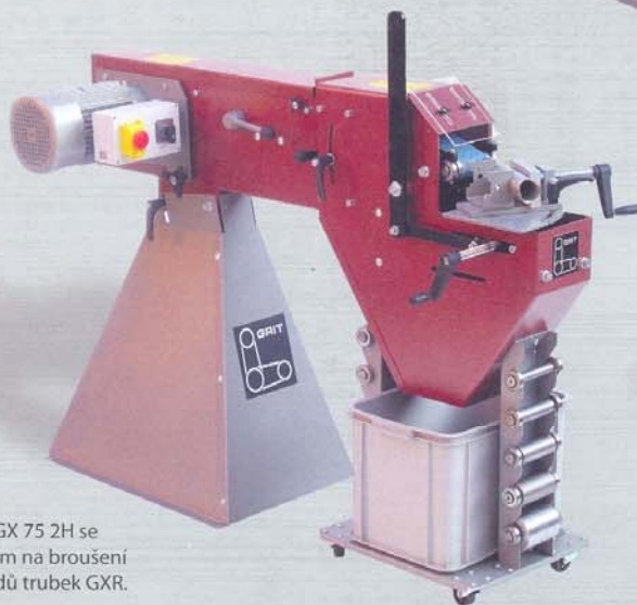
Model GX 75 2H se zařízením na broušení venkovních průměrů trubek GXC a s chlazením GXW.
